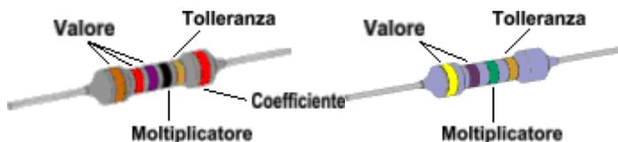
Le resistenze possiedono 4 bande colorate che permettono di stabilirne il valore.
